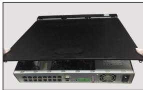
Instale la tapa y fijela con los tornillos.
