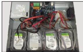
Conecte los cables de datos y alimentación.
